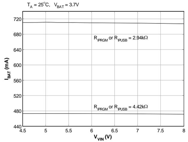
**CC AD or USB High FQ  $V_{\text{BAT}}$  Regulation**
